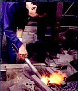
バーナーで着火した炭にふいごで風を送って炎を燃やす。温度は約1000度
